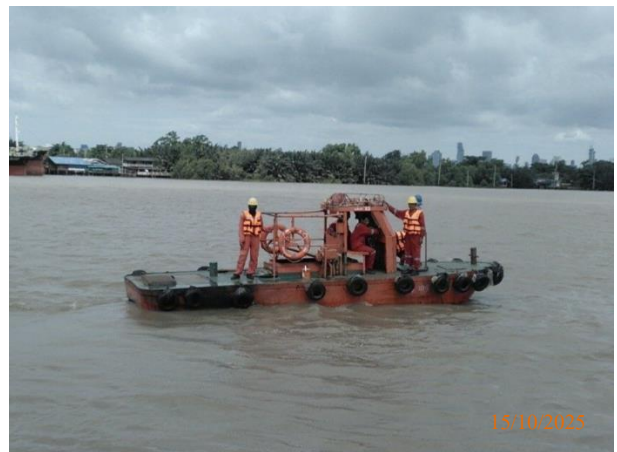
รูปที่ 2-4 เรือสนับสนุนสำหรับวาง-เก็บพันทักน้ำมัน (Boom) เมื่อเรือเข้าเทียบท่า
