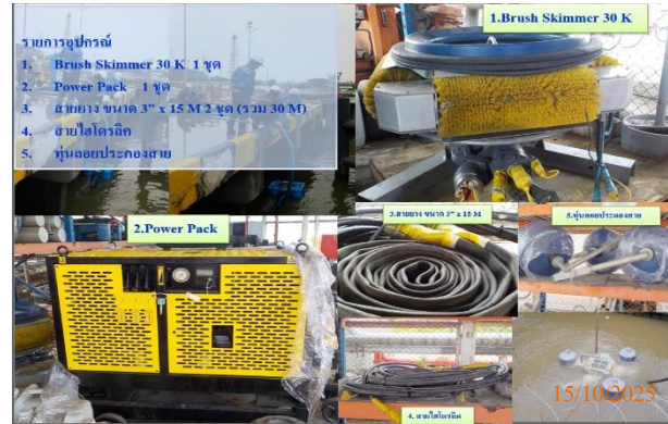
รูปที่ 2-8 อุปกรณ์สำหรับกำจัดคราบน้ำมัน กรณีเกิดการหกั่วไหล
