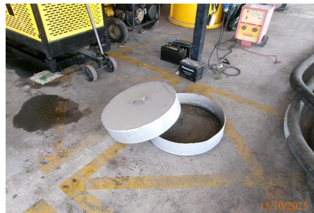
รูปที่ 2-12 ภาชนะรองรับน้ำมัน สำหรับรองรับบริเวณท่อรับ-จ่ายน้ำมัน
